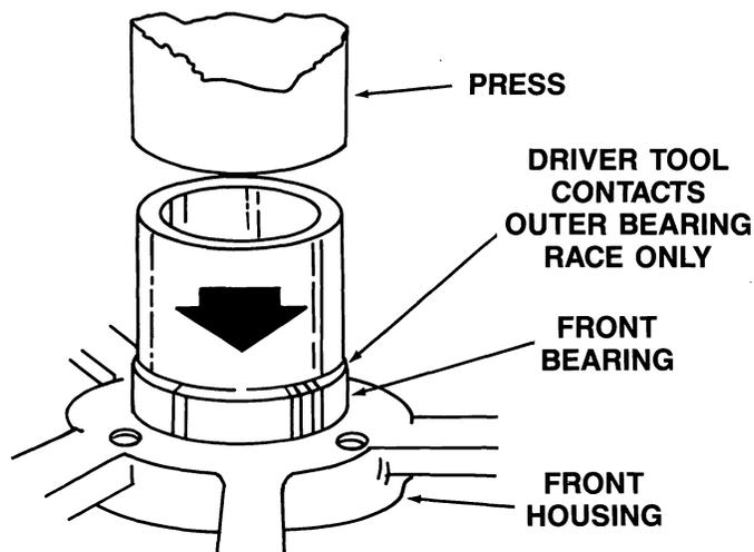
**INSTALLING FRONT BEARING**
