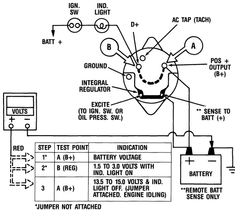
**OPEN DIODE-TRIO TEST**
