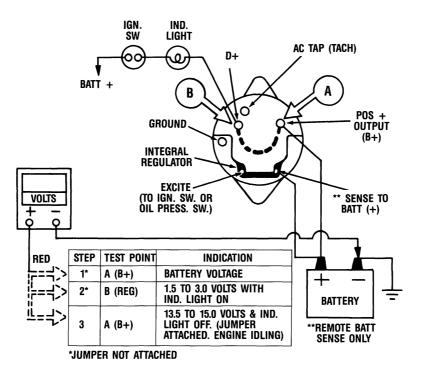
**OPEN DIODE-TRIO TEST**
