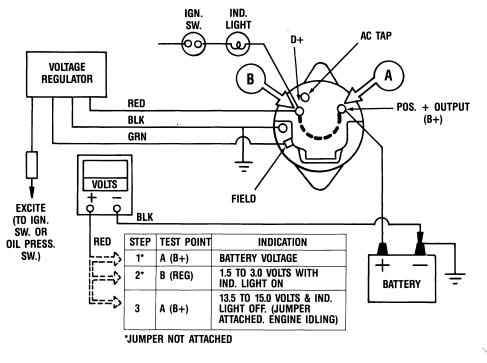
**OPEN DIODE-TRIO TEST**
