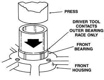
**INSTALLING FRONT BEARING**
