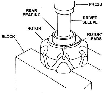
**INSTALLING REAR BEARING**
